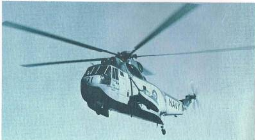
SEA KING (CHSS-2) a twin engine, turbine powered helicopter used for anti-submarine warfare duties. / Le SEA KING, (CHSS-2) hélicoptère mû par deux moteurs à turbine, sert à la détection des sous-marins.
