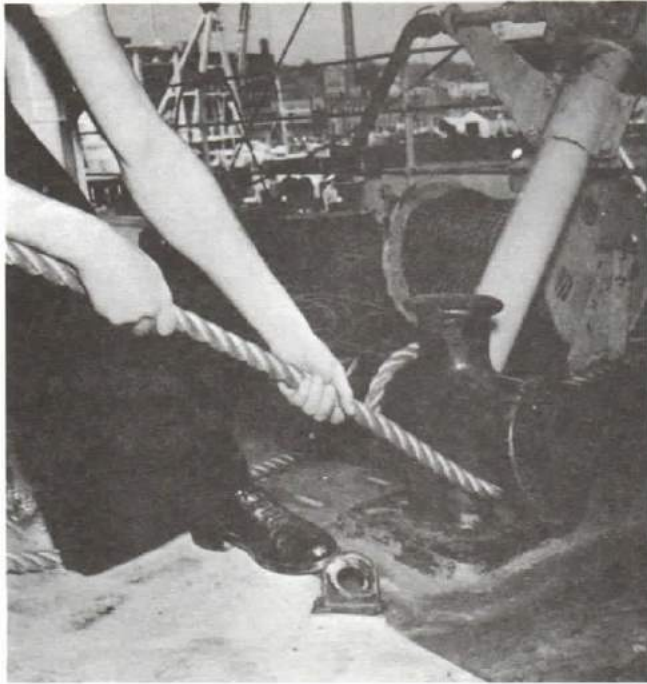
Figure 12-21 One Turn of Staghorn as for Lowering Un tour sur le biton comme pour affaler
