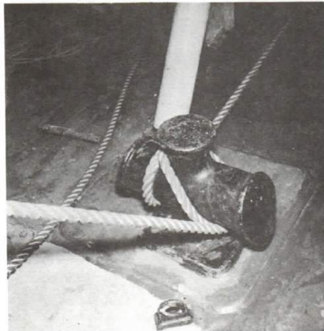
Figure 12-22 Commencing to Turn up and Secure Staghorn Commencement du tournage et de l'amarrage sur le biton
