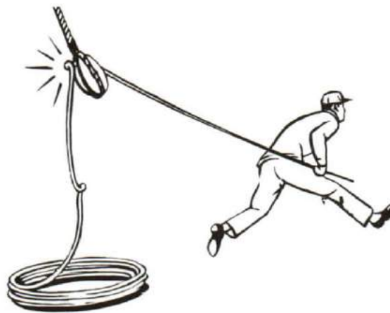
Figure 10-13 Result of Incorrect Coiling Down Résultat d'un lovage incorrect
