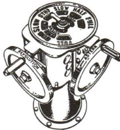
Figure 13-14 Engine Order and Revolution Telegraph Transmetteur d'ordres aux machines et indicateur de tours
